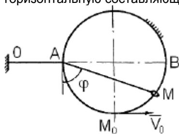
11. На тело массой  $m$ , скользящее по горизонтальной прямой, действует сила притяжения к центру  $0$ , расположенному на этой прямой. Сила притяжения пропорциональна расстоянию тела от центра  $0$ , коэффициент пропорциональности –  $k^2 m$ . Считая, что движение тела началось из пункта  $M_0$ , удаленного от центра  $0$  на расстояние  $r_0$  без начальной скорости, определить, пренебрегая трением, скорость тела в момент прохождения им центра  $0$ .
